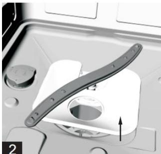
**Примечание:** при последовательности шагов от **1** к **2** система фильтрации будет демонтирована; при последовательности шагов от **2** к **1**, система фильтров будет установлена **3**.
