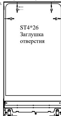
Для правой и левой стенок и четырех отверстий в верхней части посудомоечной машины используйте шурупы ST4\*26 для крепления посудомоечной машины в шкафу (подходящие саморезы)
