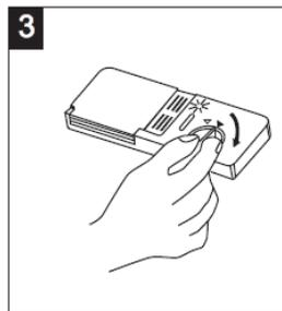
**1** Чтобы открыть дозатор, поверните крышку против часовой стрелки (налево) и поднимите ее.
